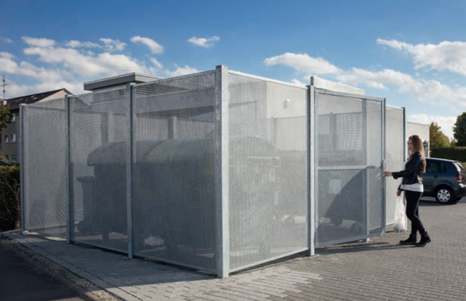
Sichtschutzwand MURO als Wertstoffumhausung, Breite x Tiefe 4580 mm x 4580 mm, Wandelemente und Flügeltüre aus Lochblech, Stahlkonstruktion feuerverzinkt
