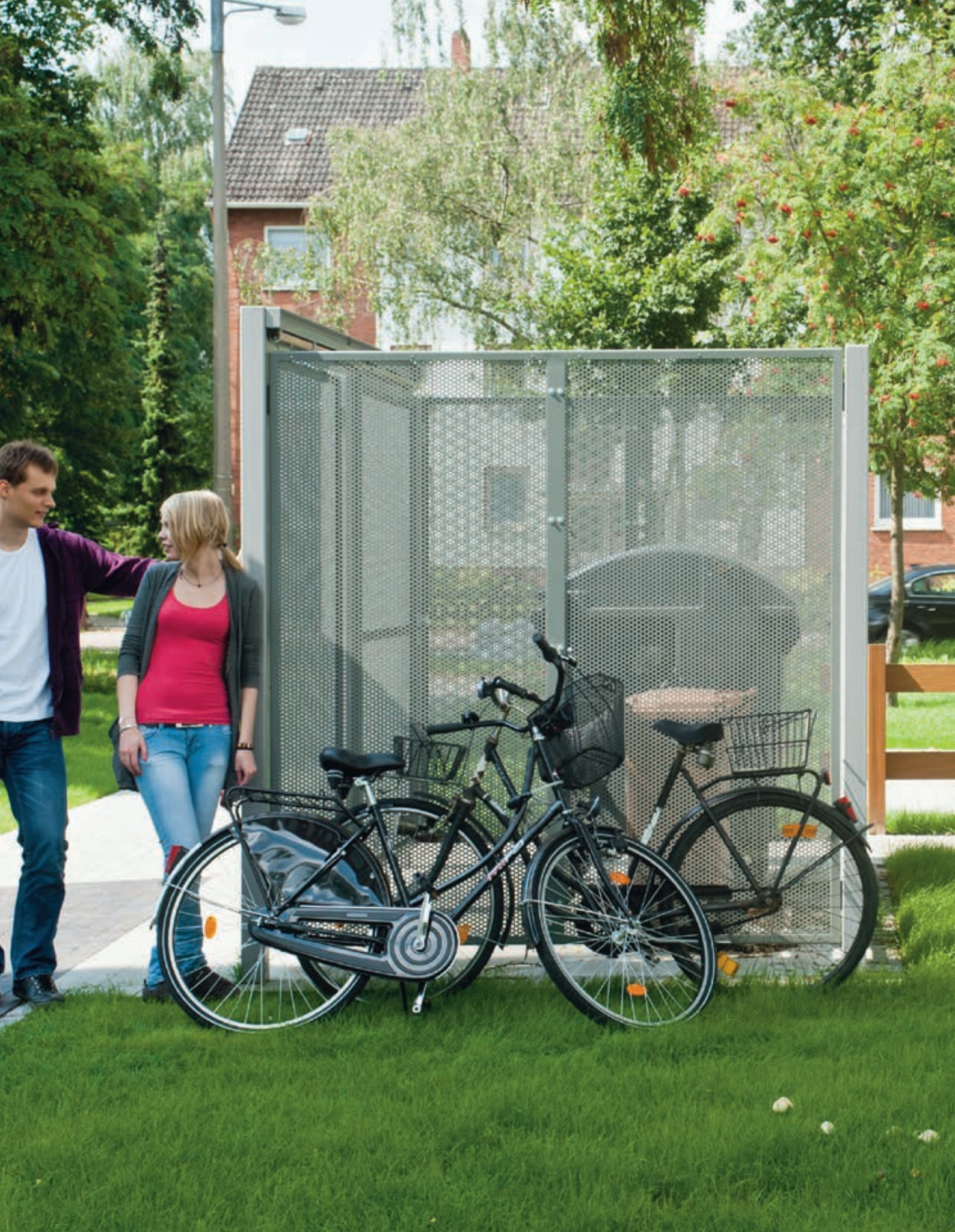
Sichtschutzwand MURO als Wertstoffumhausung, Wandelemente und Flügeltüre aus Lochblech, Stahlkonstruktion in RAL 9002 grauweiß
