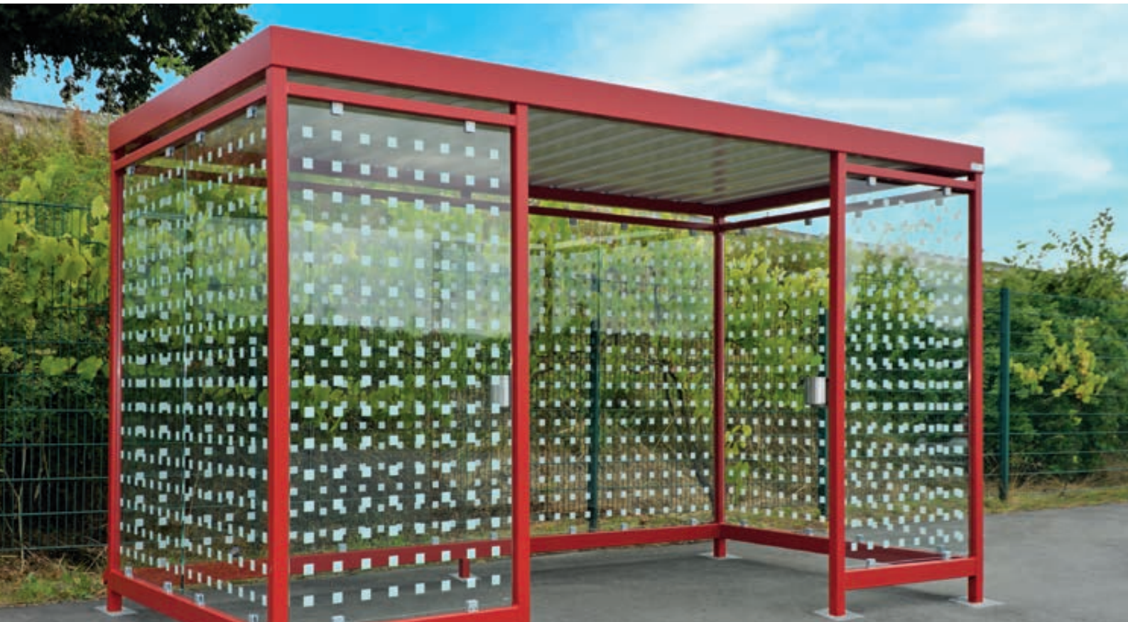
Raucherunterstand AQUILA mit auftragsbezogener Anpassung (mittiger Zugang), Dachbreite x Dachtiefe 4195 mm x 2165 mm, Rückwand Trapezblech, Seiten- und Windschutzwände mit Siebdruckdekor, Stahlkonstruktion in RAL 3000 feuerrot
