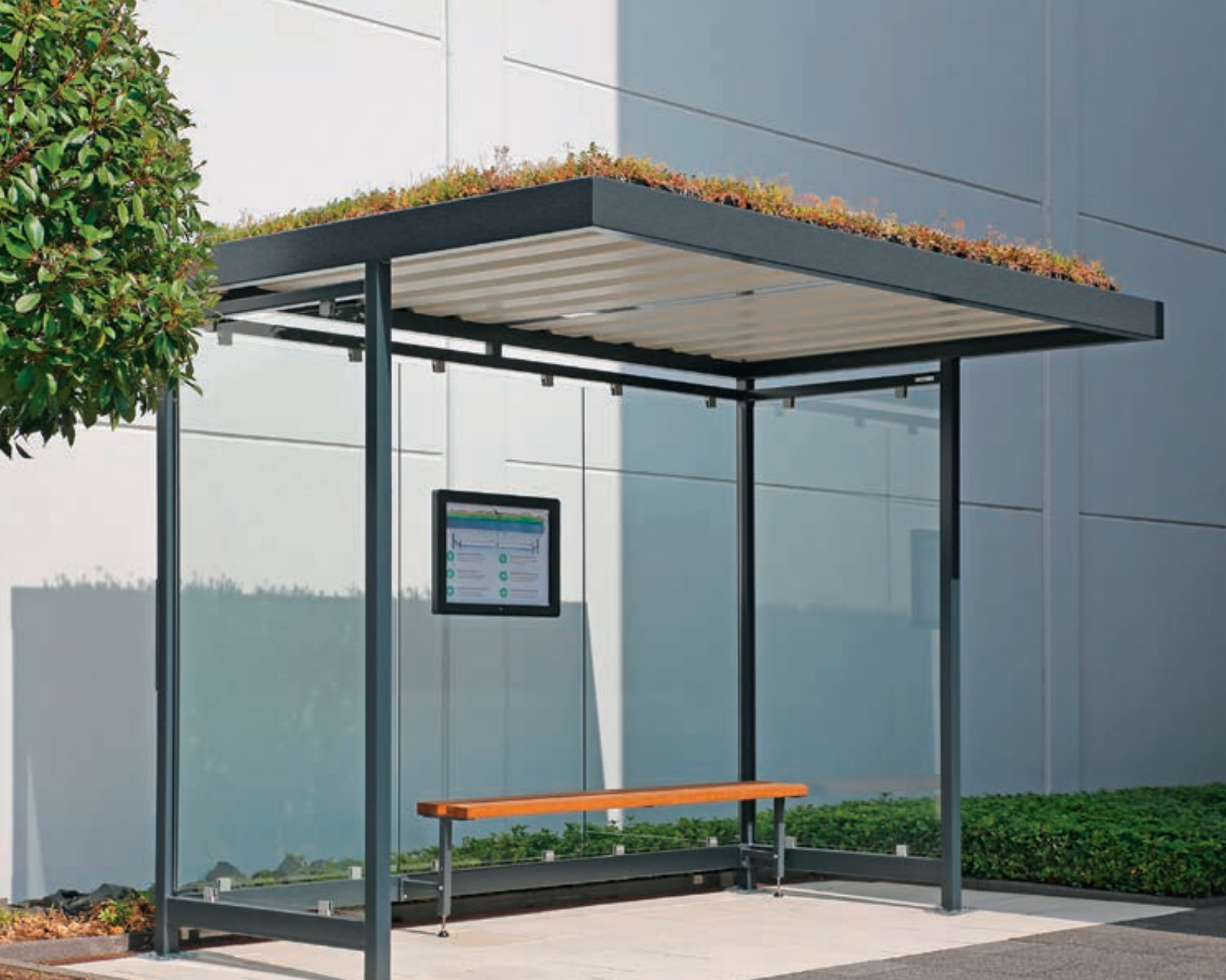
Wartehalle AQUILA GREEN, Dachbreite x Dachtiefe 3180 mm x 2165 mm, Stahlkonstruktion feuerverzinkt, grundiert und farbbeschichtet, inkl. Rück- und Seitenwänden, mit Schaukasten und Sitzbank, Dacheindeckung Trapezblech mit Dachbegrünung
