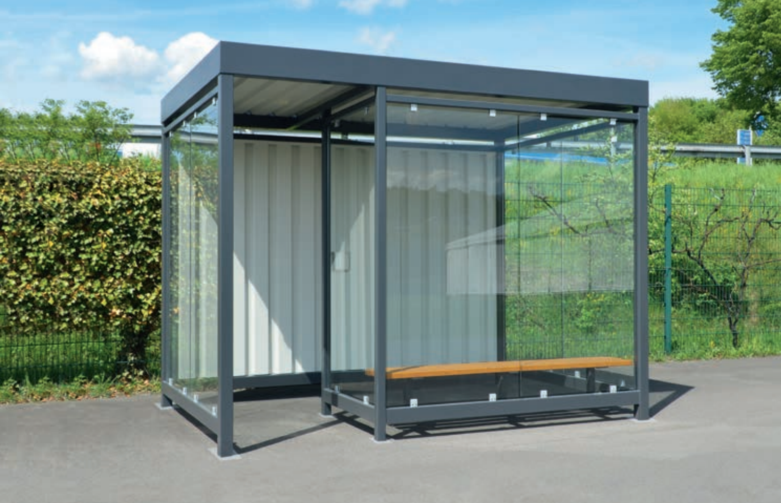
Raucherunterstand AQUILA mit auftragsbezogener Anpassung (zusätzliche Windschutzwand), Dachbreite x Dachtiefe 3180 mm x 2165 mm, Rückwand Trapezblech, Seiten- und Windschutzwände mit Siebdruckdekor, Stahlkonstruktion in RAL 7016 anthrazitgrau
