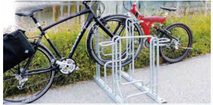
Reihenparker TACOMA doppelseitig 90°, tief / hoch, zum Aufdübeln bei +/- 0 mm, 4 Stellplätze, feuerverzinkt
