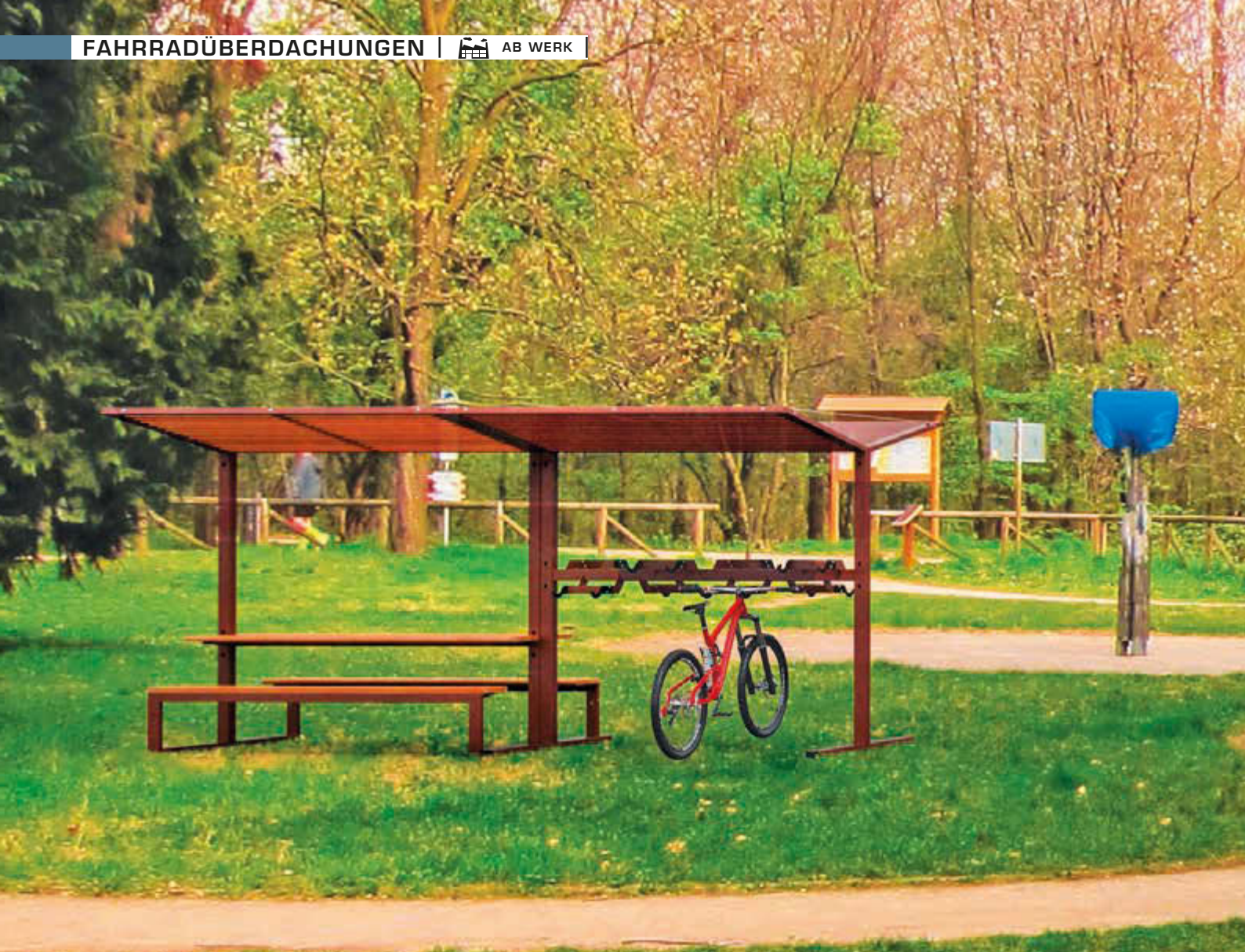
Fahrradüberdachung CISON in Verbindung mit Freizeitüberdachung CISON (auf Anfrage), Lamellendach aus Holz, 2 x Breite 2200 mm x Tiefe 2495 mm, mit integriertem Lenkerhaltesystem, Stahlkonstruktion in RAL 8017 schokoladenbraun
