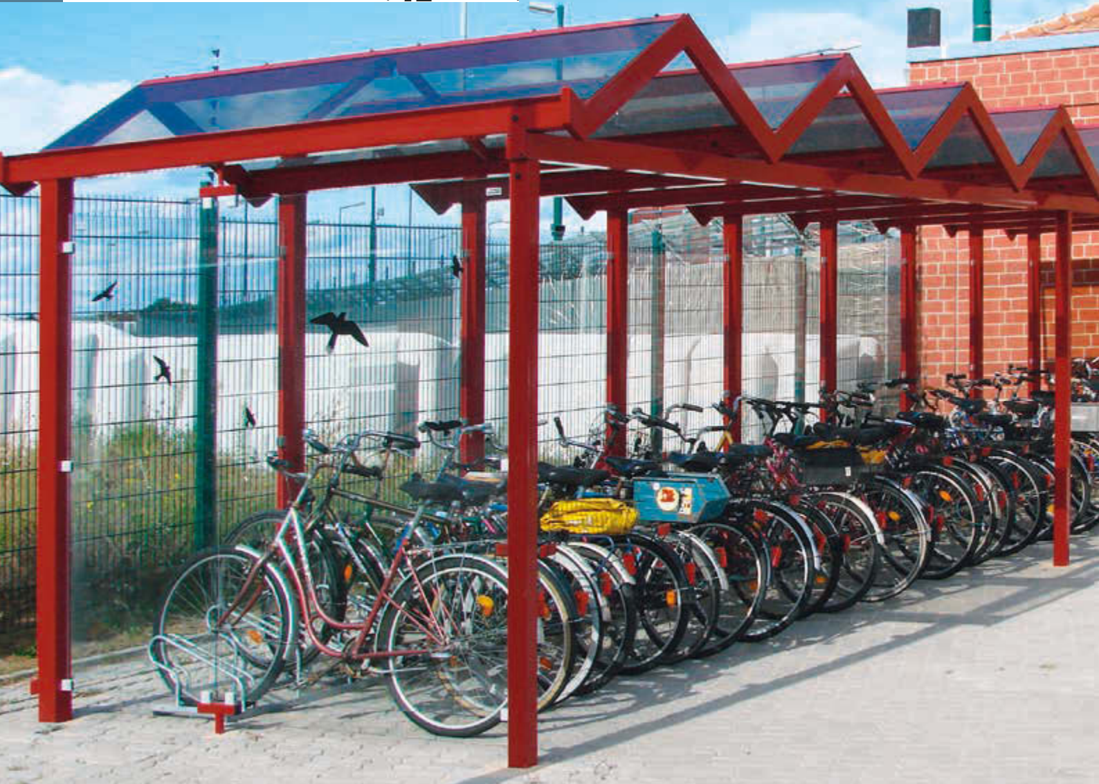
Fahrradüberdachung TANGENTA, einseitig, auftragsbezogene Anpassung mit Unterzug und Seitenwandtiefe von 2100 mm, Dachbreite x Dachtiefe 12200 mm x 2250 mm, Rück- und Seitenwände ESG, Klarglas, auftragsbezogene Dachverglasung in bronze, Stahlkonstruktion in RAL 3011 braunrot
