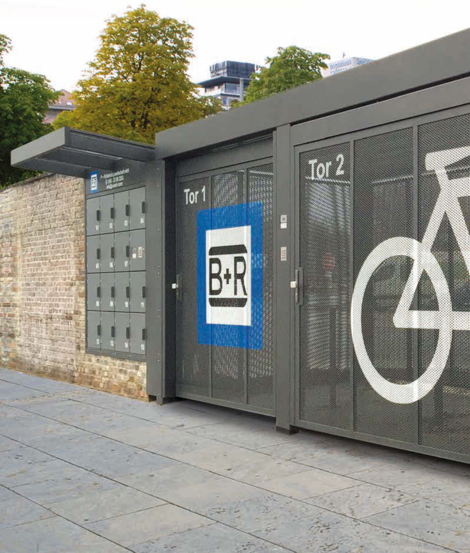
Fahradüberdachung MULTI-PORT-E für Doppelstock-Fahrradparksysteme, auftragsbezogene Anpassung, Dachbreite x Dachtiefe 9850 mm x 2580 mm, jeweils mit Fernsteuerung und Anlagenüberwachung STATION-CONTROL, Stahlkonstruktion RAL 7016 anthrazitgrau
