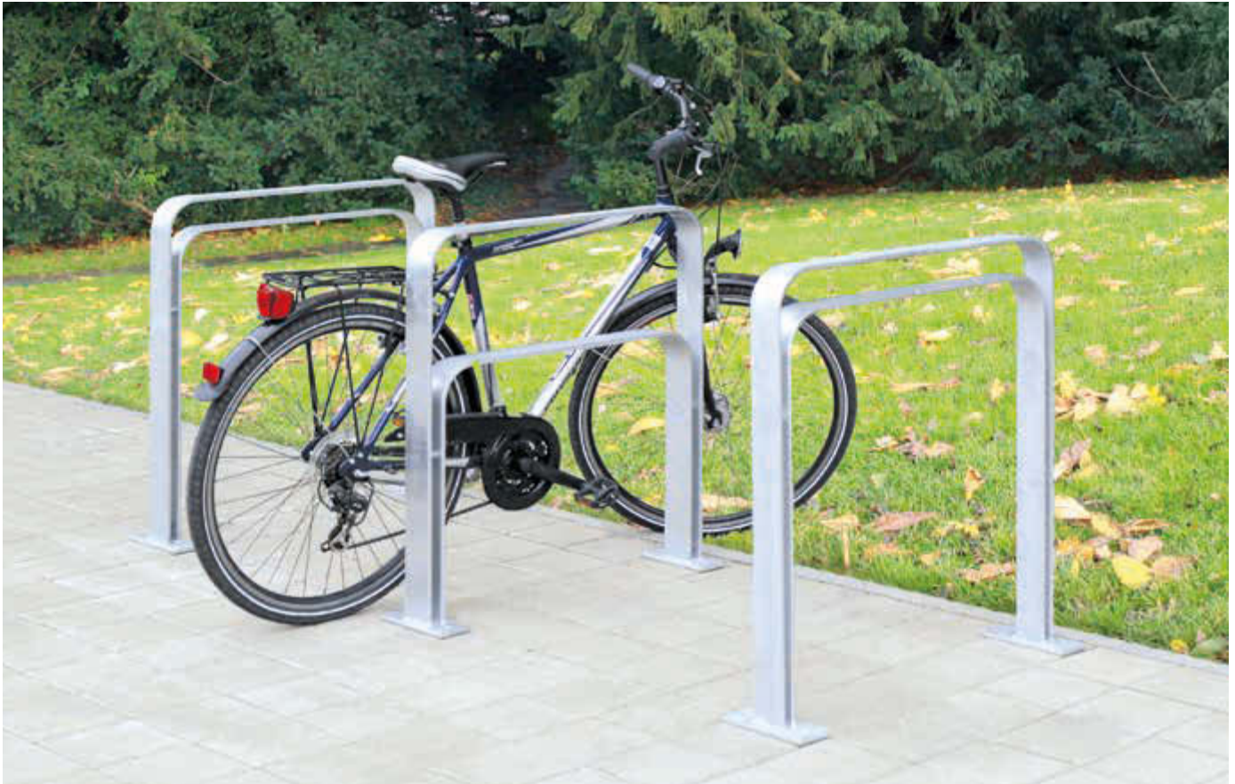
Anlehnbügel TAMPA mit Innenbügel mittig bzw. hoch, zum Aufdübeln, Breite 850 mm, feuerverzinkt
