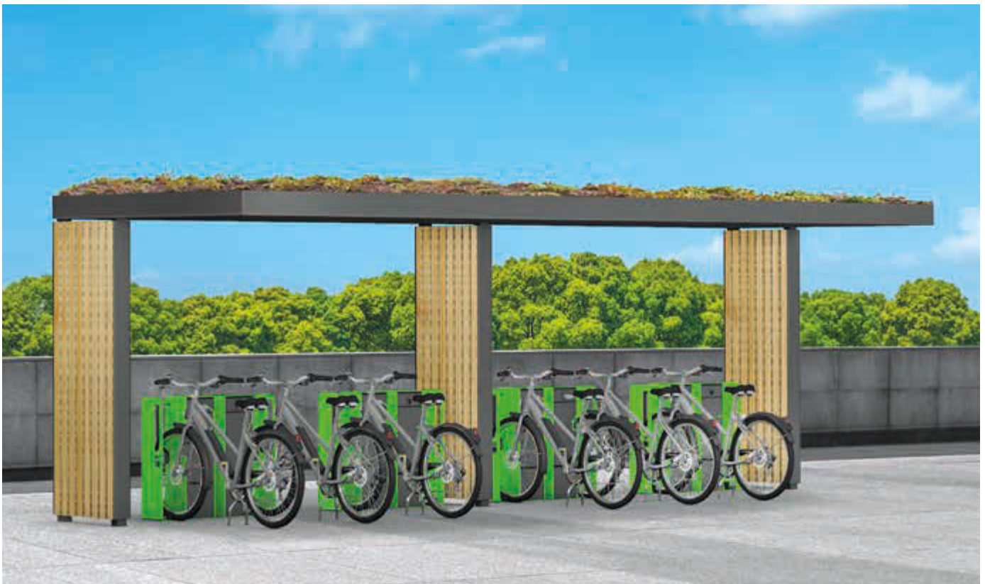
Fahrradüberdachung GEMINI, auftragsbezogene Anpassung, Dachbreite x Dachtiefe ca. 9000 x 2400 mm, mit beidseitig beplankten Wandelementen, Lärche lasiert, Dachbegrünung, Fahrrad-Abstellanlage VELO-CONNECTOR mit Ladeschließfach, Stahlkonstruktion in RAL 7016 anthrazitgrau
