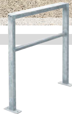
▲ Anlehnbügel ELGIN mit Quersteg, zum Aufdübeln, Breite 850 mm, feuerverzinkt
