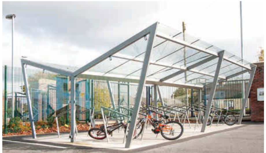
Fahrradüberdachung EDGE, doppelseitig, Dachbreite x Dachtiefe 7740 mm x 5115 mm, Dacheindeckung VSG, Klarglas, mit Seitenwänden und Anlehnbügel EDGETYRE, Stahlkonstruktion in RAL 7047 telegrau
