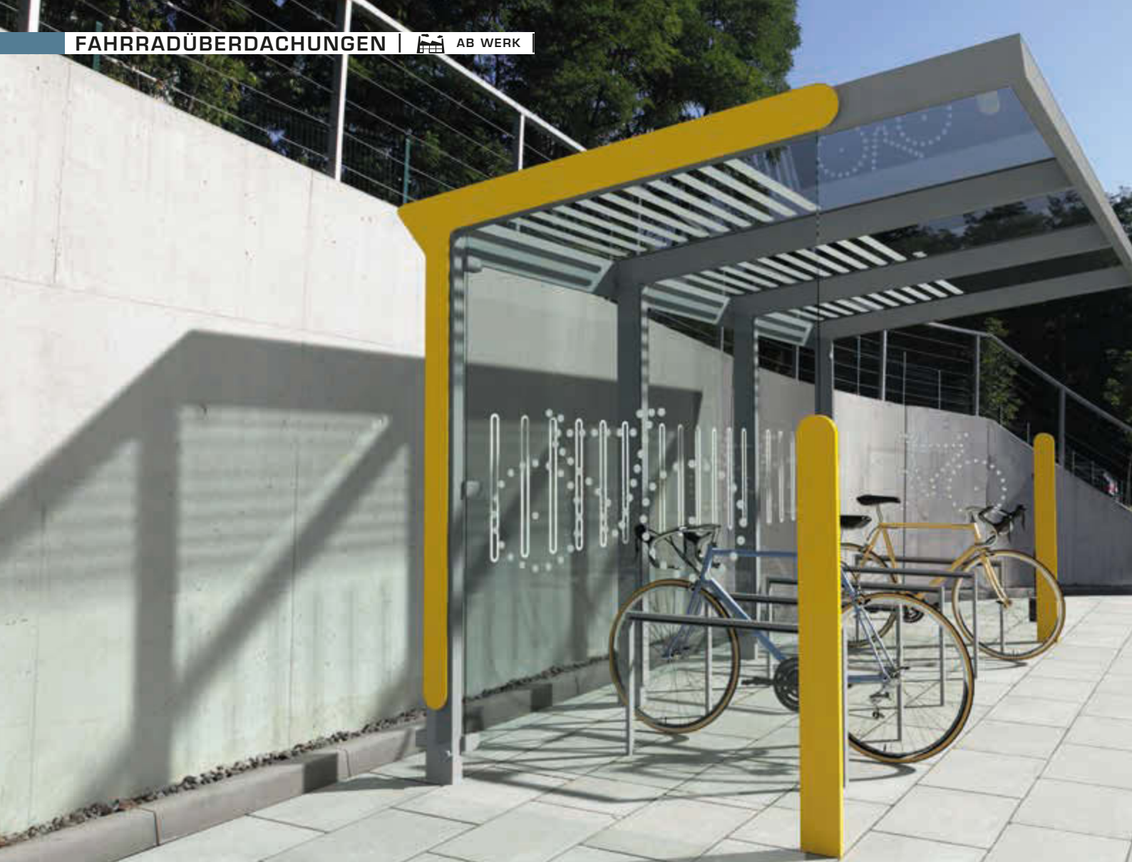
Fahrradüberdachung AUREO VELO mit Pultdach, Dachbreite x Dachtiefe 4175 mm x 2500 mm, inklusive Rück- und Seitenwänden ESG, Klarglas mit Siebdruckdekor, mit Anlehnbügel EDGETYRE, Dach mit Siebdruckstreifen, vordere Seitenpfosten mit auftragsbezogener Anpassung in RAL 1006 maisgelb, Stahlkonstruktion in RAL 9007 graualuminium
