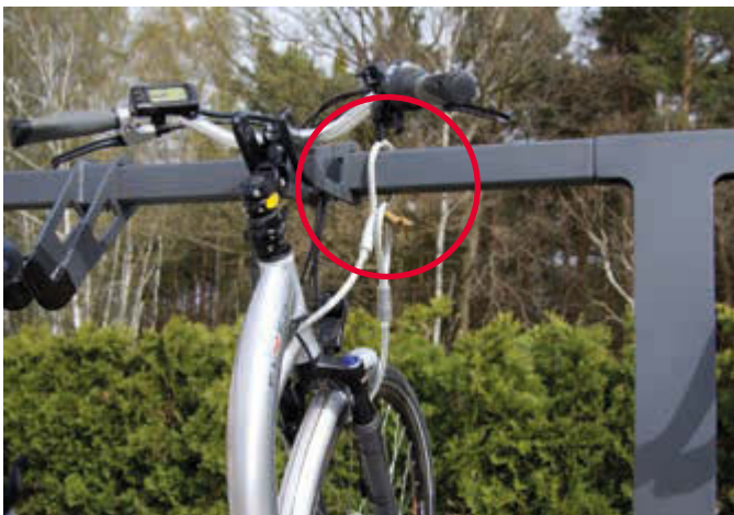
▲ Sicherungsseil zum sicheren Abschließen: durch das Vorderrad durchziehen und die Endschleufe mit der Seilanfangsschleufe mittels bauseitigem Vorhängeschloss sichern
