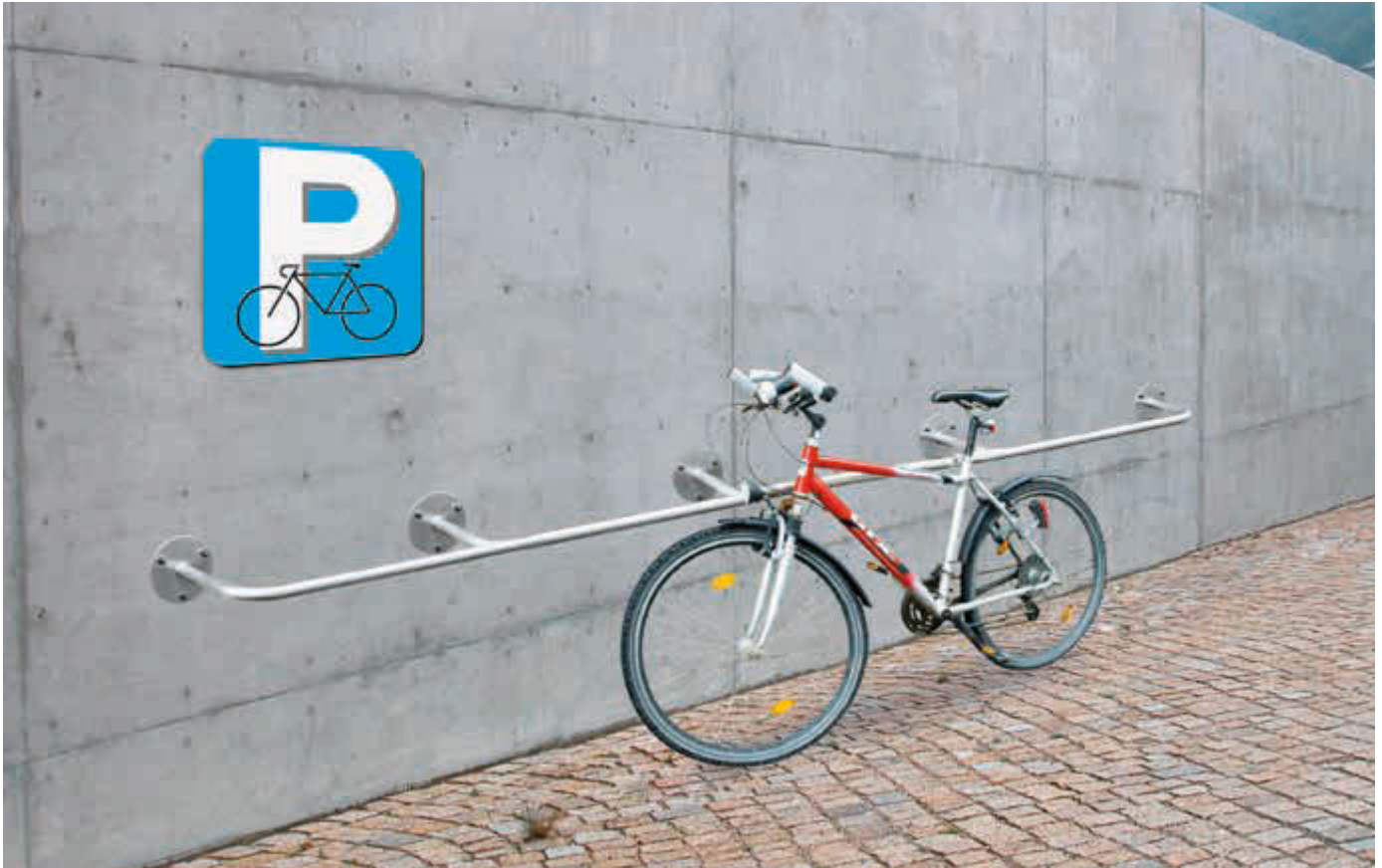
Wandanlehnbügel JEFFERSON bestehend aus 1 Anfangs-, 2 Mittel- und 1 Endbügel, feuerverzinkt
