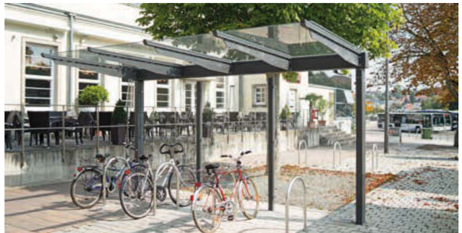
Fahrradüberdachung VIRGO, Dachbreite x Dachtiefe 4720 mm x 2250 mm, einseitig, Rückwand ESG, Klarglas, Scheibendekorbeklebung bauseits, Stahlkonstruktion in DB 703 eisenglimmer
