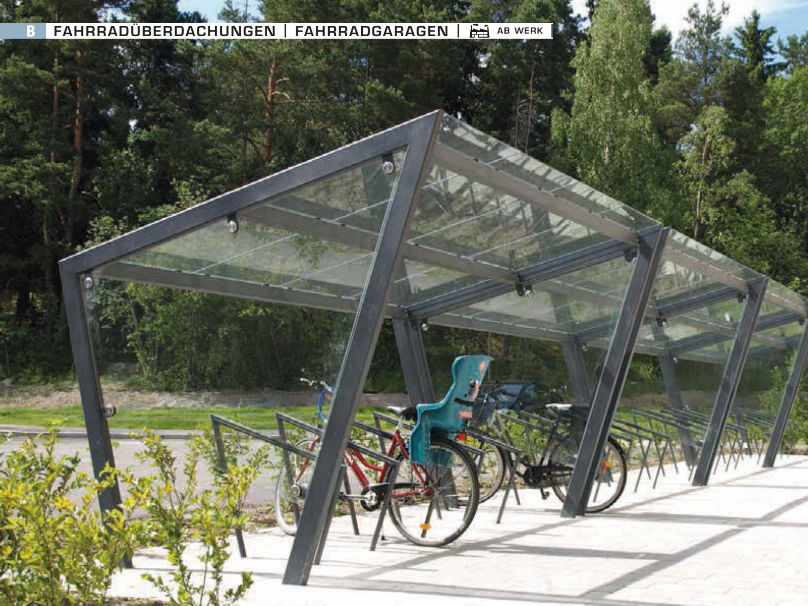
Fahrradüberdachung EDGE, einseitig, 4 x Dachbreite x Dachtiefe 3900 mm x 2500 mm in Reihe gestellt, Dacheindeckung VSG, Klarglas, mit Seitenwänden und Anlehnbügel EDGETYRE, Stahlkonstruktion in RAL 7016 anthrazitgrau
