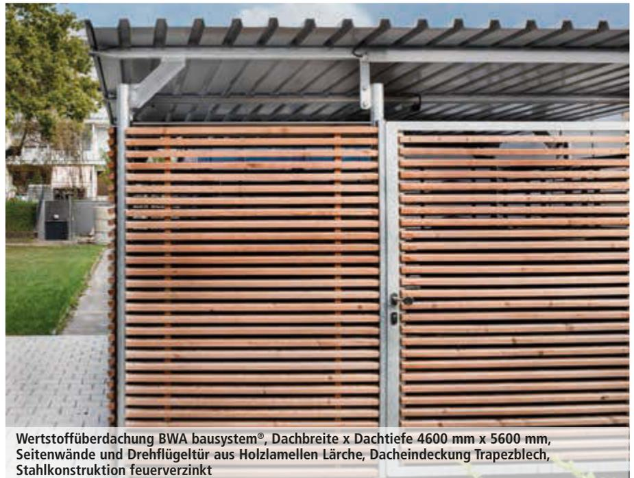
**Wertstoffüberdachung BWA bausystem®, Dachbreite x Dachtiefe 4600 mm x 5600 mm, Seitenwände und Drehflügeltür aus Holzlamellen Lärche, Dacheindeckung Trapezblech, Stahlkonstruktion feuerverzinkt**
