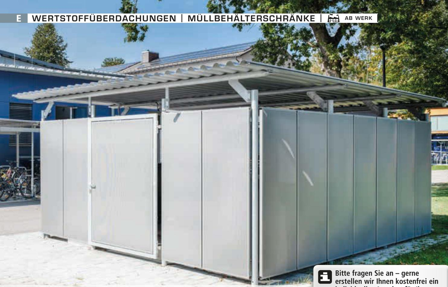
Wertstoffüberdachung BWA bausystem®, Dachbreite x Dachtiefe 4600 mm x 5600 mm, Seitenwände und Drehflügeltür aus Aluminiumlochblech, Dacheindeckung Stahlwellblech, Stahlkonstruktion feuerverzinkt
