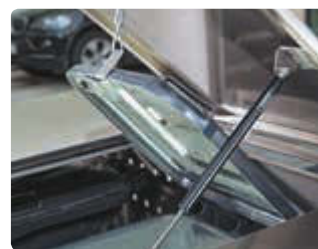
▲ Klappdach mit Gasdruckdämpfer
