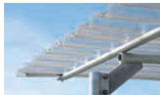
▲ Hohlkammer-Wellplatten aus Polycarbonat, farblos, extrem schlagzäh, schwer entflammbar B1, hagelfest gemäß Garantieerklärung, mit UV-Schutz, für Schneelasten bis 1,25 kN / m²
