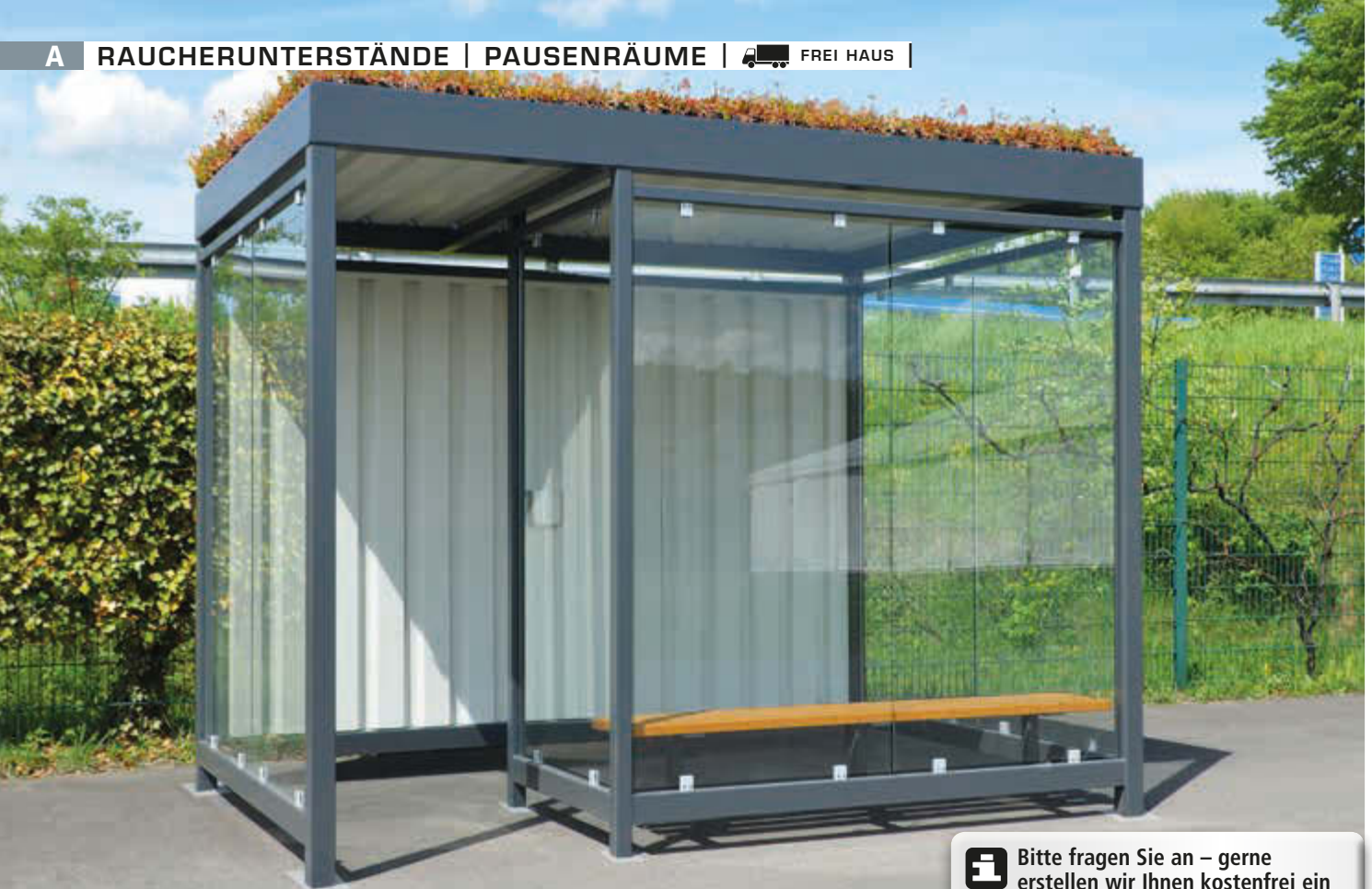
Raucherunterstand AQUILA GREEN mit auftragsbezogener Anpassung (zusätzliche Windschutzwand), Dachbreite x Dachtiefe 3180 mm x 2165 mm, Rückwand Trapezblech, Seiten- und Windschutzwände, ESG, Klarglas, Sitzbank, Stahlkonstruktion in RAL 7016 anthrazitgrau
