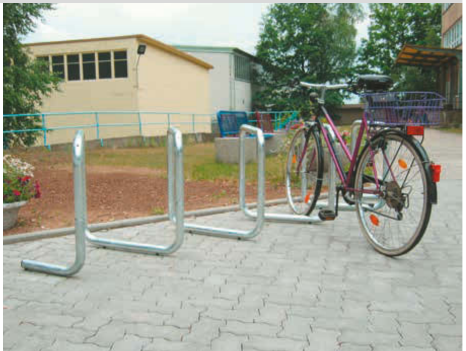
Fahrrad-Parkschnecke ATLANTA, 1 Grund- und 1 Anbaueinheit bei einseitiger Nutzung für 5 Stellplätze bzw. 10 Stellplätze bei doppelseitiger Nutzung
