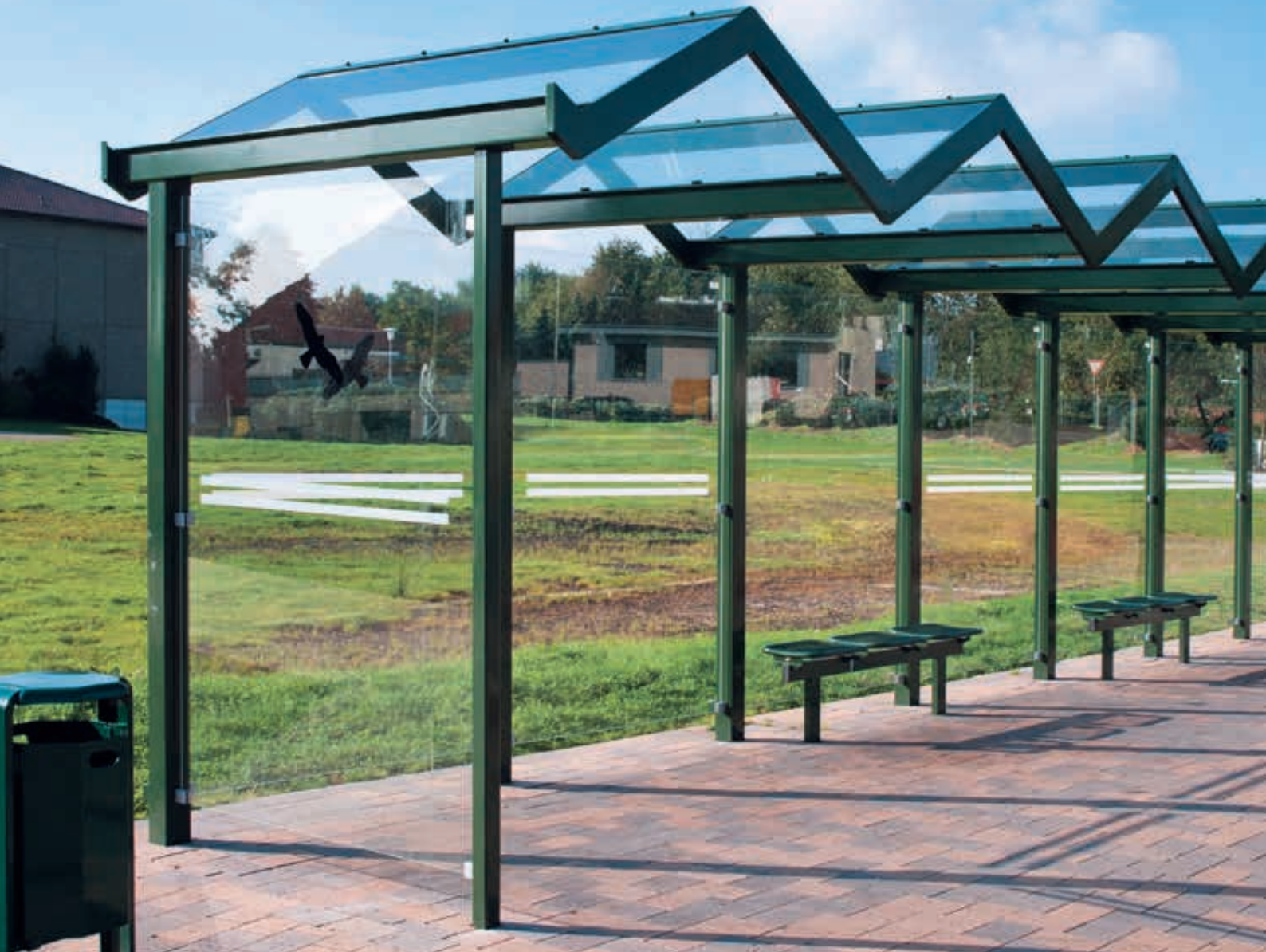
Wartehalle TANGENTA mit auftragsbezogener Anpassung, Dachbreite x Dachtiefe 10700 mm x 2000 mm, Rück- und Seitenwände ESG, Klarglas mit Siebdruckstreifen und Raubvogelaufkleber, mit Sitzbank TARVIS und Abfallbehälter COVENTRY, Stahlkonstruktion in RAL 6020 chromoxidgrün
