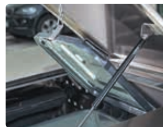
▲ Klappdach mit Gasdruckdämpfer
