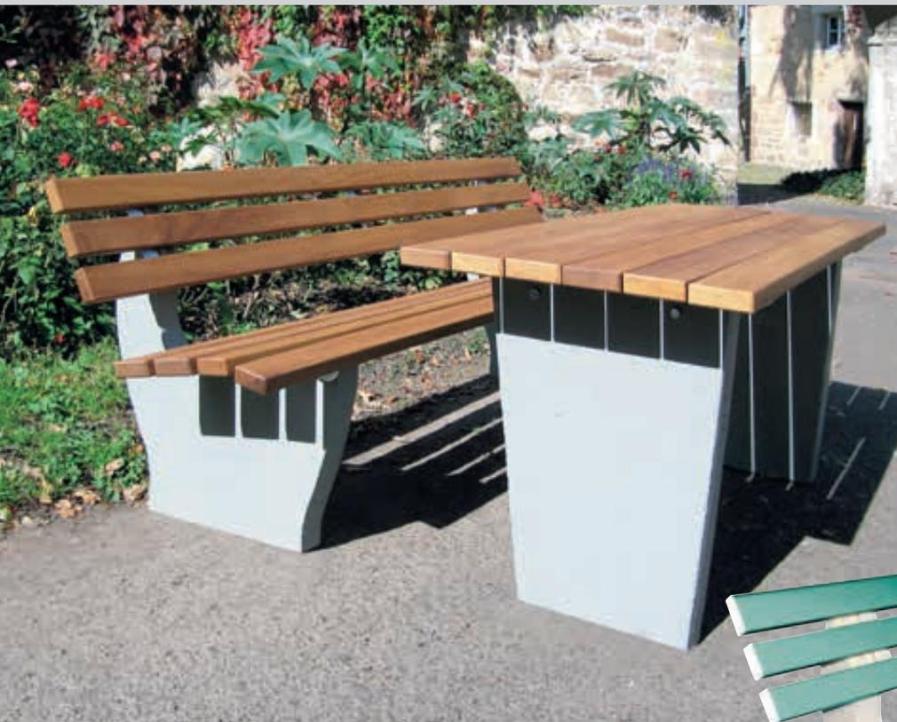
**Konstruktion:** Sitzbank und Tisch mit Betonfüßen. Sitzfläche, Rückenlehne und Tischfläche mit Holzbelattung bzw. Kunststoffbelattung. PVC-Latten wahlweise mit Holzeinlage oder verzinktem Stahlkern.
