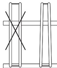
▲ optimierte Form: hinten enger für sicheren Stand
