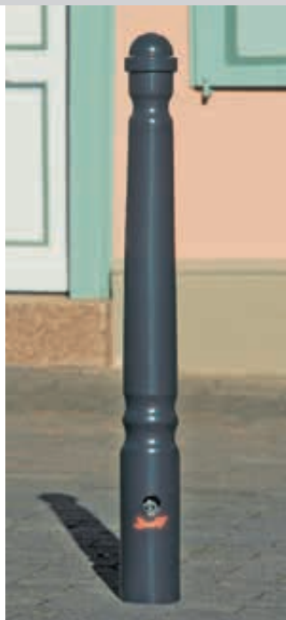
Poller KATALONIA mit Ringtaille, herausnehmbar aus Bodenhülse, mit Dreikantschloss, in RAL 7021 schwarzgrau
