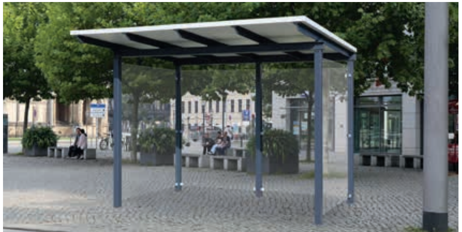
Wartehalle PEGASUS, Dachbreite x Dachtiefe 3300 mm x 2000 mm, mit Dacheindeckung Stahlblechkassetten, mit Rück- und Seitenwände ESG, Klarglas, Stahlkonstruktion in RAL 7016 anthrazitgrau
