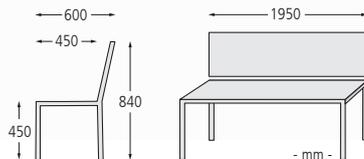
▲ Sitzbank LIGURIA mit Rückenlehne, zum freien Aufstellen, mit Stahlauflage, Stahlteile in DB 703 eisenglimmer
