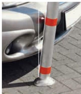
Die Bodenplatte ist mit einem Federmechanismus versehen, der den Sperrpfosten nach einem eventuellen Anfahren (bis etwa 30° Neigung) selbsttätig wieder aufrichtet.
