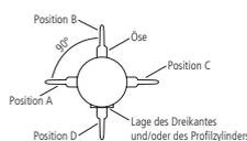
Bei kippbaren Pfosten empfehlen wir **keine** Ösenmontage, wenn unbedingt gewünscht, schließen wir Rückgabe und Umtausch aus.
