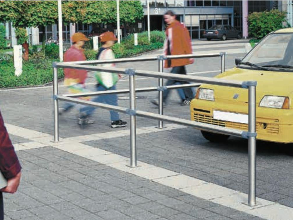
**Konstruktion:** Standrohre Ø 60 mm aus Stahl oder Edelstahl. Querrohre wahlweise in Ø 48 oder Ø 60 mm, bei Edelstahlausführung nur in Ø 60 mm erhältlich. Schellen und Kappen (Flachkopf) aus Aluminium mit Edelstahlschrauben. Beliebige horizontale Winkel über 90° und vertikale Winkel (Steigungen) bis 45° einstellbar.
