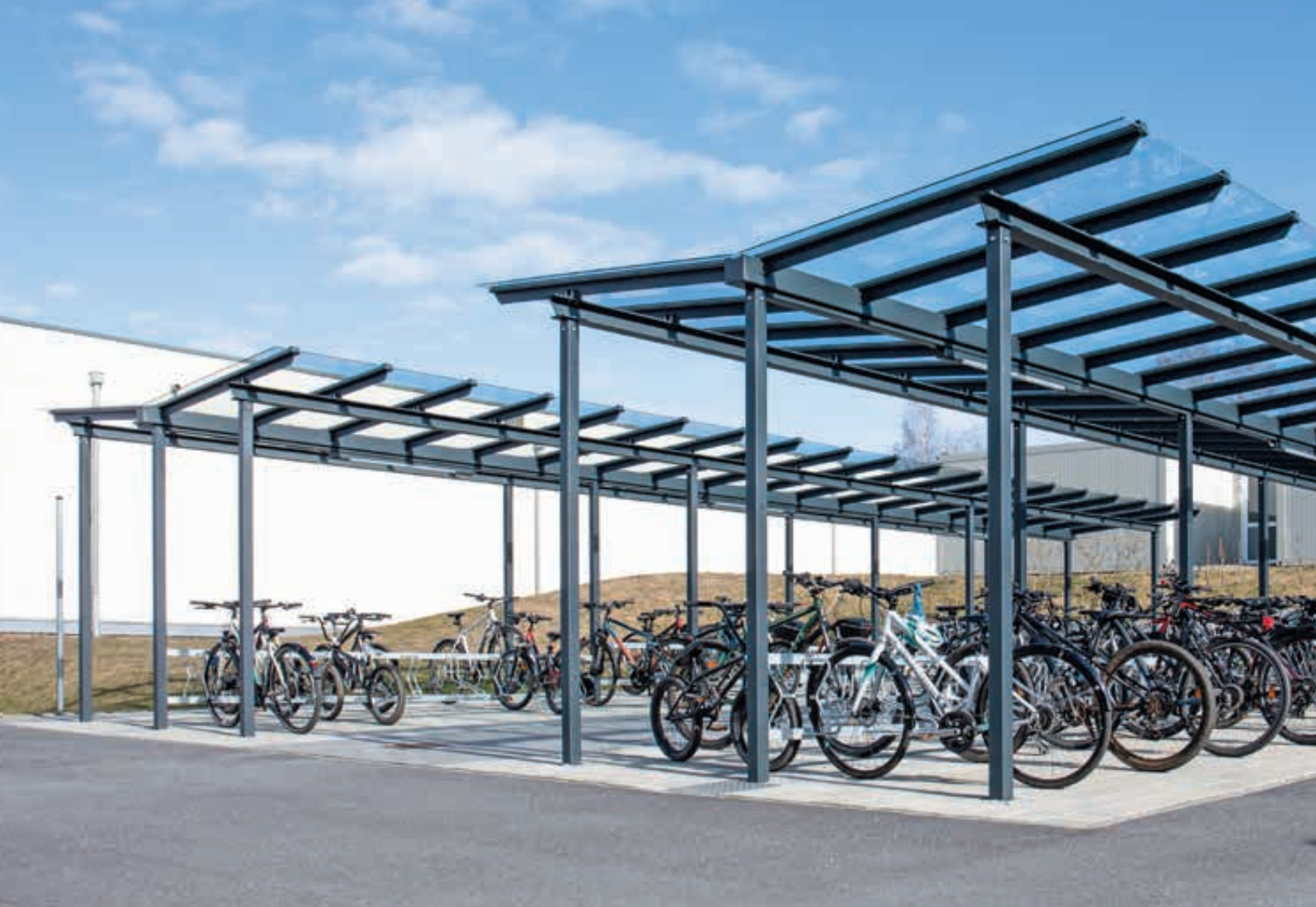
Fahrradüberdachung PEGASUS, Dachbreite x Dachtiefe 13800 mm x 4500 mm, Fahrradständer MADISON, Stahlkonstruktion in RAL 7016 anthrazitgrau
