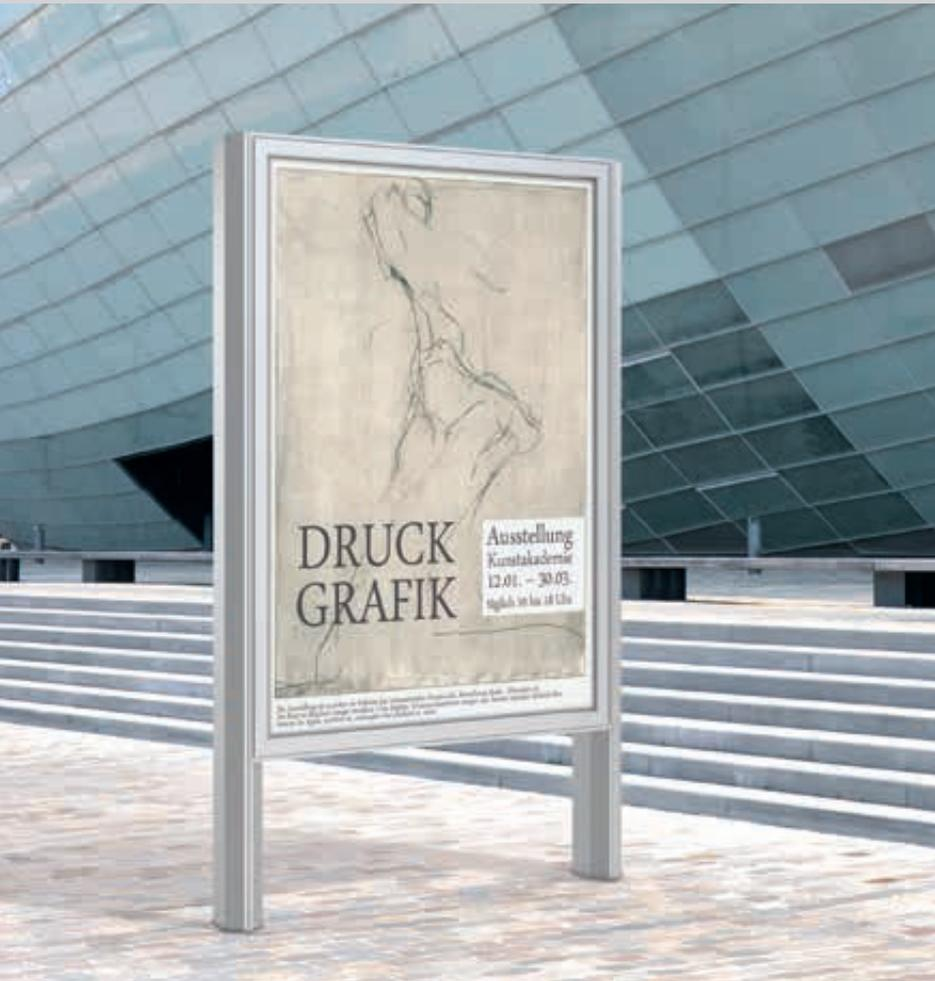
**Konstruktion:** Einseitig bzw. doppelseitig nutzbarer Schaukasten aus einer wartungsfreien Aluminium-Konstruktion mit verwindungsfreien eckigen Profilen sowie integrierten Be- und Entlüftungsöffnungen gegen das Beschlagen der Scheibe. Der Klappflügel öffnet sich mittels Gasdruckfedern selbstständig nach oben und wird in der Offen-Stellung sicher gehalten. Der Schaukasten ist an der Unterseite mit 2 bzw. 4 Dreikantschlössern ausgestattet (je Schloss 1 Schlüssel im Lieferumfang enthalten).
