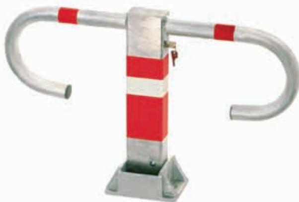
**Konstruktion:** Sehr stabile Stahlkonstruktion aus Profilstahl, Bügel-Ø 43 mm. Mit Bodenplatte aus Aluguss. Im umgelegten Zustand geringe Bauhöhe von 80 mm.
