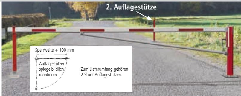
**Konstruktion:** Wegesperre bestehend aus 1 Hauptstütze (Ø 102 mm) und 2 höhenverstellbaren Auflagestützen (70 x 40 mm) aus Stahl. Rechteckiger Sperrbalken (86 x 46 mm) aus Hartaluminium, drehbar gelagert mit Antisitzschutz. Auflagestützen sind höhenverstellbar (+ 100 / - 100 mm). Einfaches und leichtes Drehen mittels PTFE-Lager. Ab 4,5 m Sperrweite mit Diagonalstrebe aus Aluminium.
