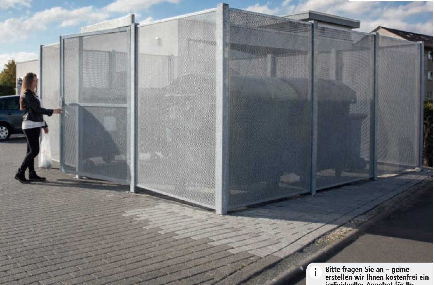
Sichtschutzwand MURO als Wertstoffumhausung, Breite x Tiefe 4580 mm x 4580 mm, Wandelemente und Flügeltüre aus Lochblech, Stahlkonstruktion feuerverzinkt
