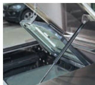
▲ Klappdach mit Gasdruckdämpfer
