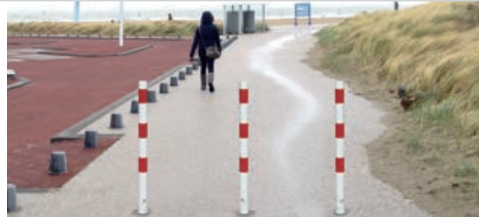
Sperrpfosten GERODA zum Einbetonieren, Ø 60 mm, herausnehmbar aus Bodenhülse mittels Dreikantschloss, feuerverzinkt und pulverbeschichtet
