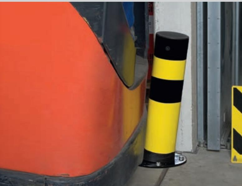
**Konstruktion:** Flexibler Rammschutzpoller aus Stahl (Ø 159 mm), Wandstärke 4,5 mm. Die innen liegende Stahl-Spiralfeder in Verbindung mit dem elastischen Puffer aus Polyurethan absorbiert die auftretenden Anfahrkräfte - bis 25° neigbar.
