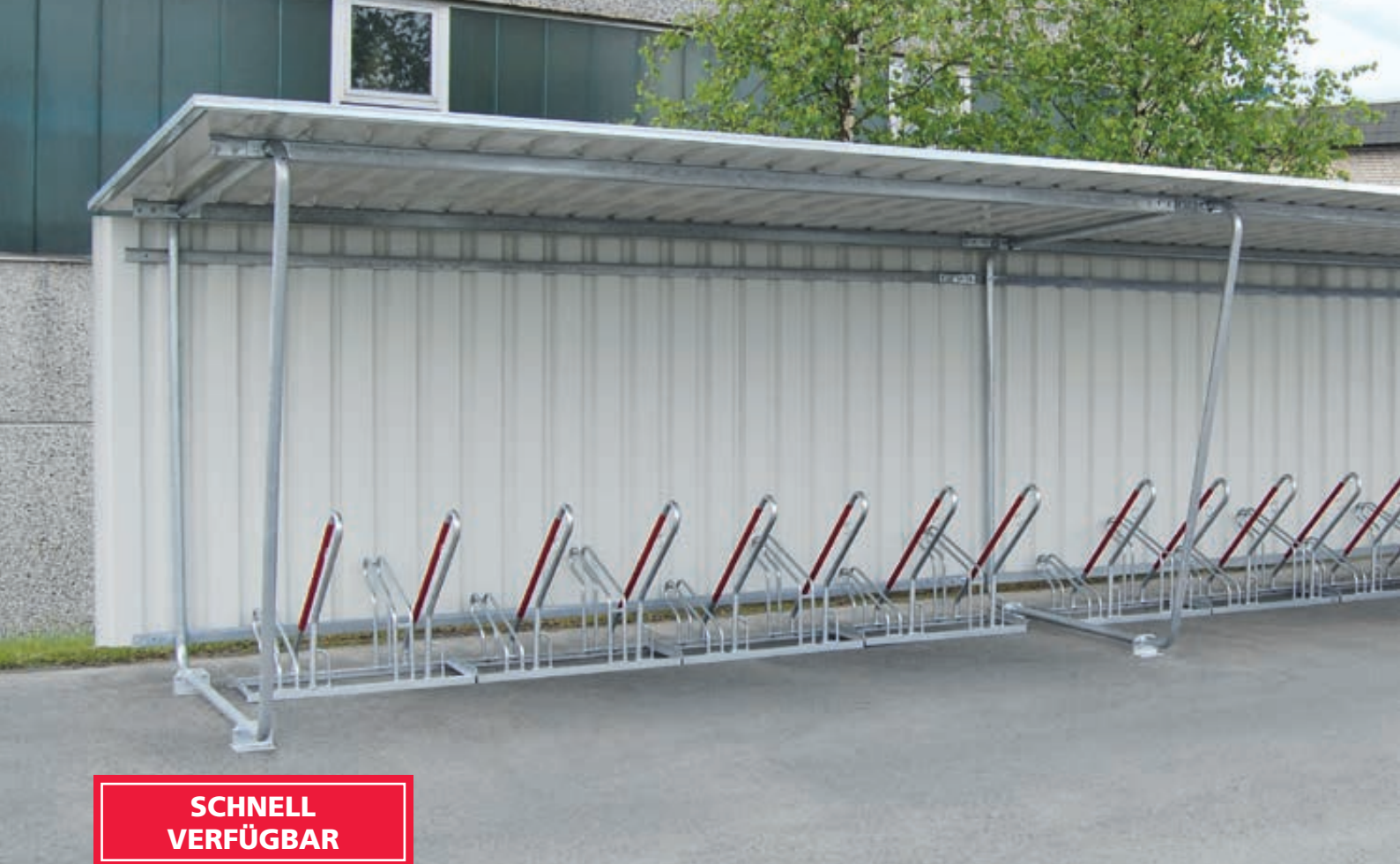
Fahrradüberdachung INDUS, Dachbreite x Dachtiefe 9150 mm x 2330 mm, einseitig, mit Rück- / Seitenwand sowie Fahrradständer NEW YORK, Stahlkonstruktion feuerverzinkt
