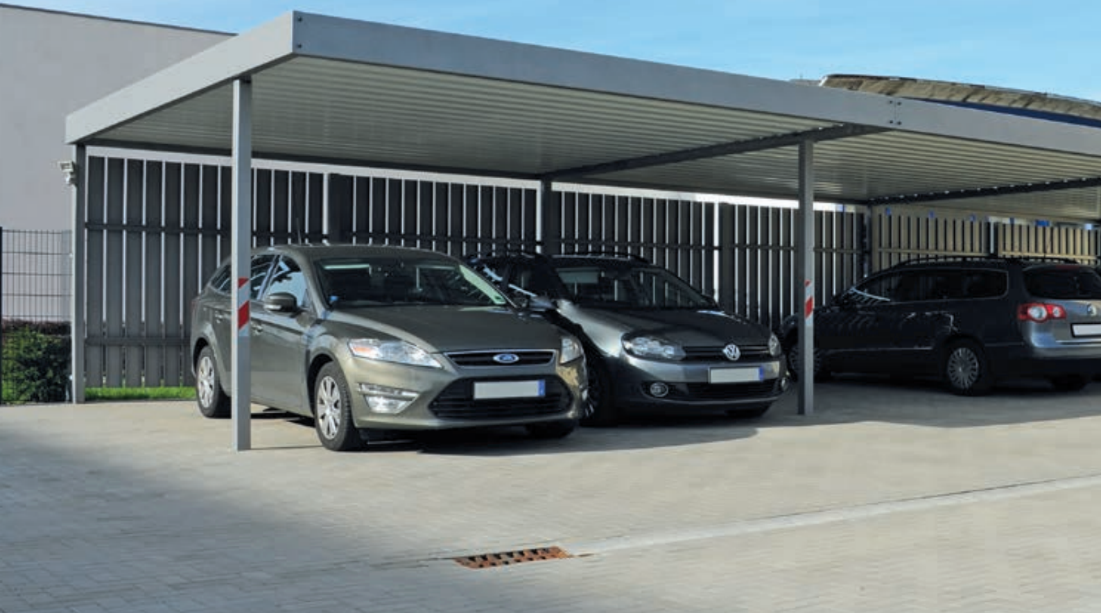
Pkw-Überdachung Z02 mit auftragsbezogener Anpassung, für 6 Pkw, Dachbreite x Dachtiefe 15190 mm x 5810 mm, Rückwand mit Stahlblechpaneelen, Stahlkonstruktion und Stahlblechpaneelle in RAL 9007 grau aluminium
