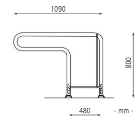
▲ Radeinstellung einseitig tief, zum Aufdübeln, langer Bügel, (Reihenaufstellung)
