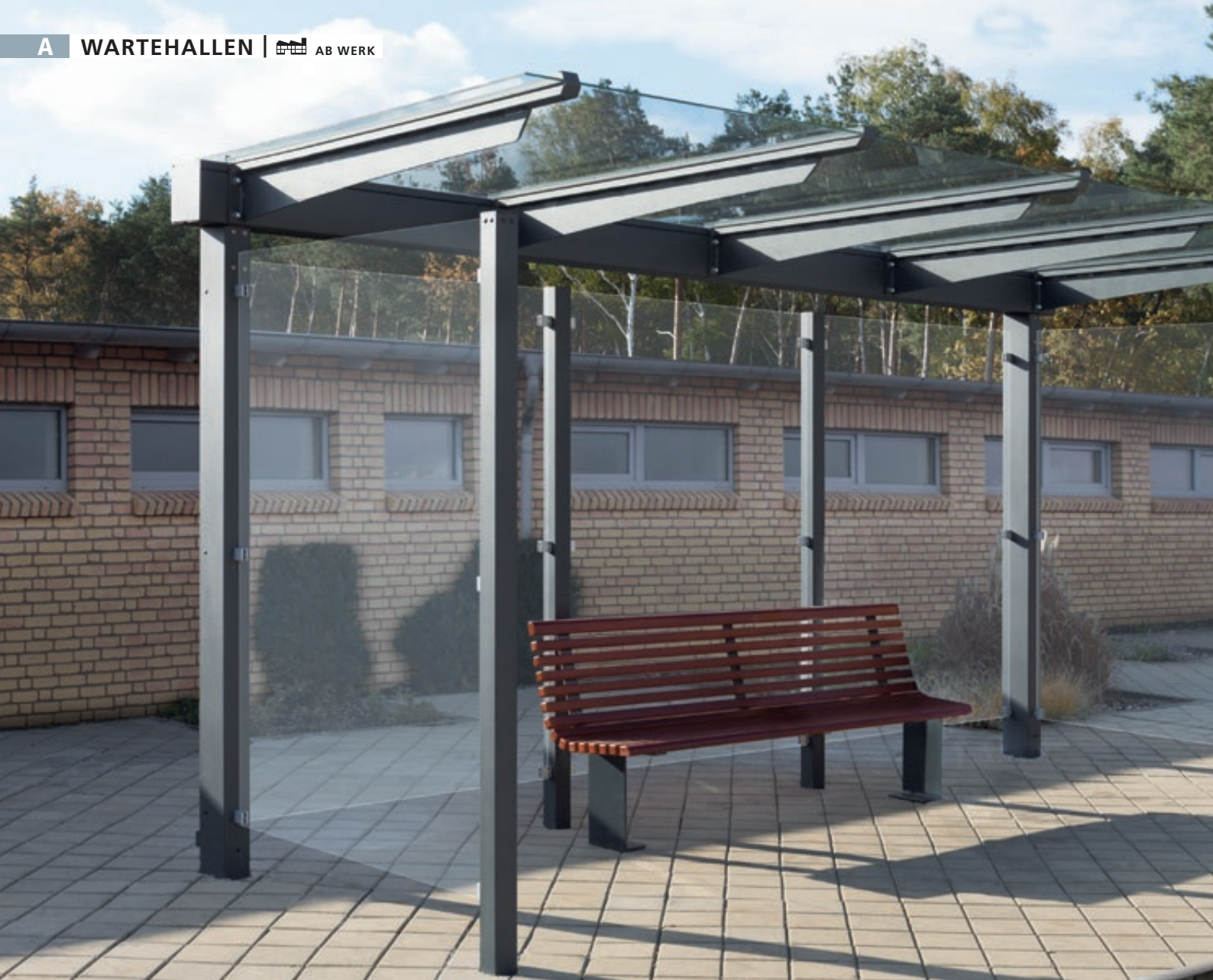
Wartehalle VIRGO einseitig, Dachbreite x Dachtiefe 4720 mm x 1800 mm, mit Rück- / Seitenwänden ESG, Klarglas sowie Sitzbank PESCARA, Stahlkonstruktion in RAL 7016 anthrazitgrau
