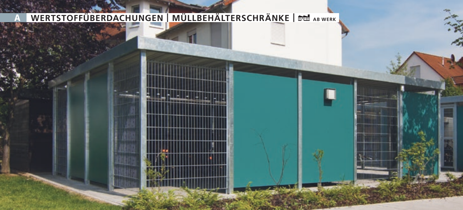
Wertstoffüberdachung FLEXI-BOX, Dachbreite x Dachtiefe 6300 mm x 7800 mm (auftragsbezogene Anpassung), Wandelement / Drehflügeltür, einflügelig, aus Doppelstabgittermatten und Trespa®-Fassadenbautafeln in mittelgrün, Stahlkonstruktion feuerverzinkt
