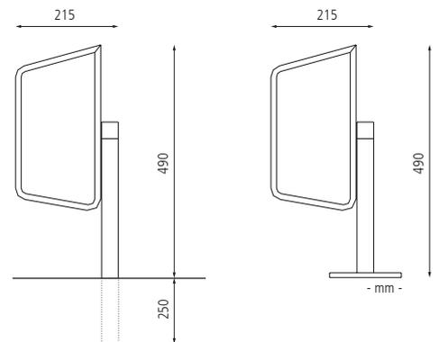
▲ zum Einbetonieren
