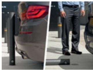
Das austauschbare Verbindungsstück bricht an der Sollbruchstelle (hier: Standardausführung ohne Wegrollsicherung).
