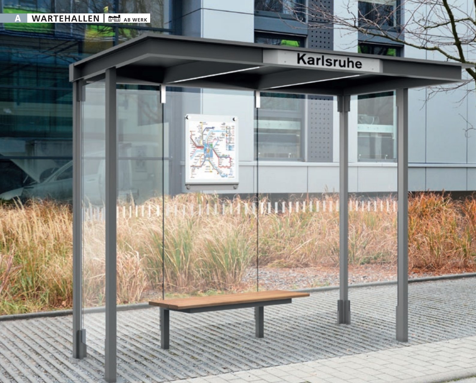
Wartehalle HOREC, Dachbreite x Dachtiefe 2955 mm x 1484 mm, mit Rück- und Seitenwänden Verbundsicherheitsglas (VSG), mit Sichtstreifen, Sitzbank mittig, Fahrplanschaukasten und LED-Beleuchtung, Stationsschild auftragsbezogene Anpassung in RAL 9016 verkehrswies, Stahlkonstruktion in RAL 9007 grau aluminium
