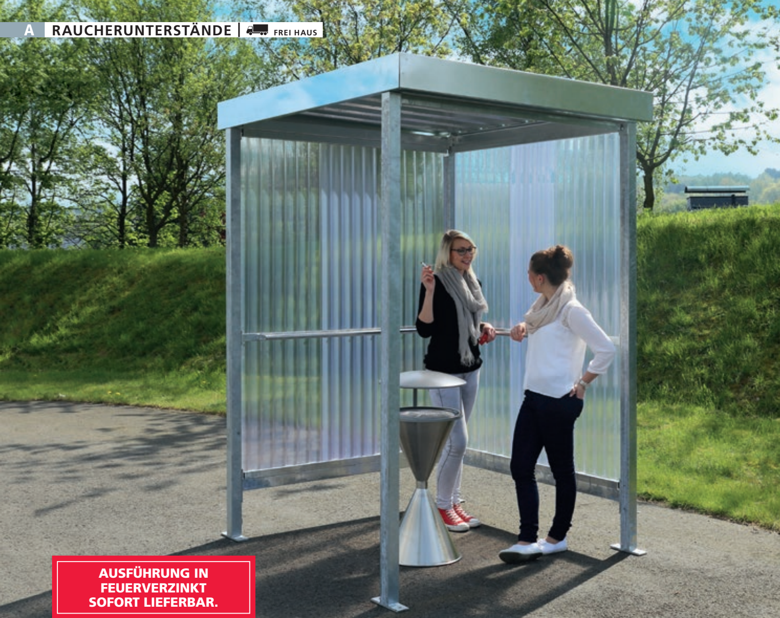
Raucherunterstand CIGAR, Dachbreite x Dachtiefe 1720 mm x 1580 mm, inklusive Rück- / einer Seitenwand, integrierter Anlehnmöglichkeit, mit Ascher, Stahlkonstruktion feuerverzinkt
