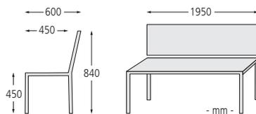
▲ Sitzbank LIGURIA mit Rückenlehne, zum freien Aufstellen, mit Stahlauflage, Stahlteile in DB 703 eisenglimmer
