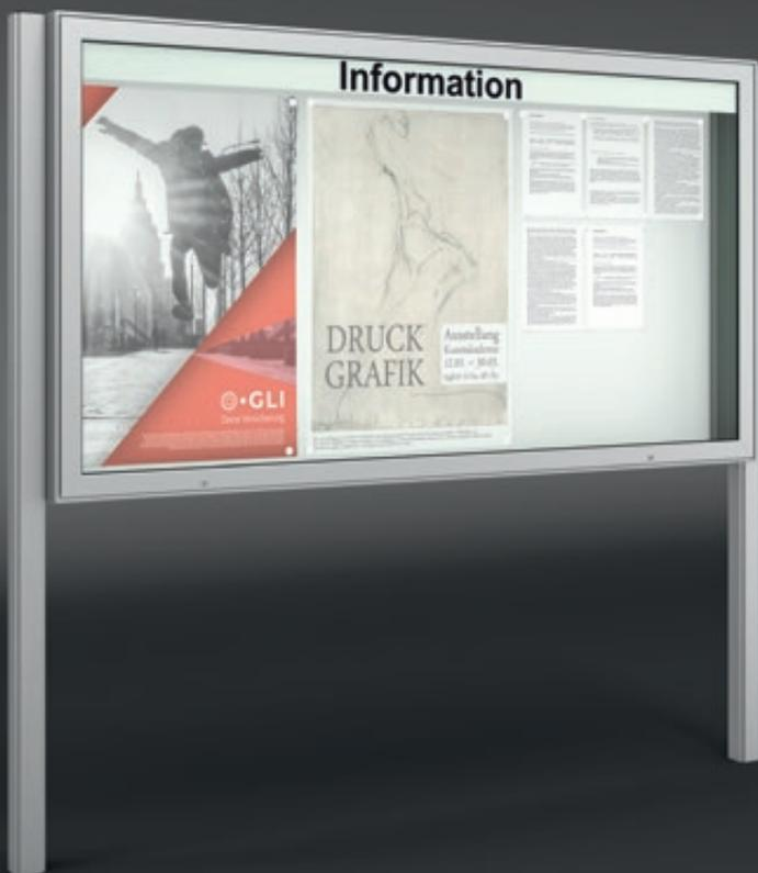
**Konstruktion:** Doppelseitig nutzbarer Schaukasten aus Aluminium. Ecken spitz. Verdeckt liegende Be- und Entlüftung gegen Beschlagen der Scheibe. Klappflügel-Öffnung mit Gasdruckfeder nach oben. Automatische Arretierung in geöffneter Stellung. Inkl. Schriftblende (ohne Beschriftung) und Sicherheitsschlössern mit je 2 Schlüsseln. Ständer im Lieferumfang enthalten. 10 Magnete inklusive. Beleuchtung siehe Zubehör.
