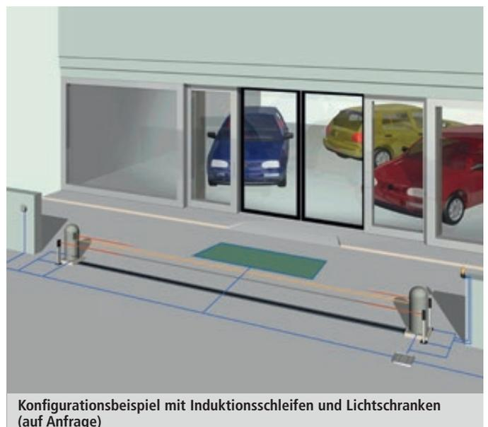
Konfigurationsbeispiel mit Induktionsschleifen und Lichtschranken (auf Anfrage)
