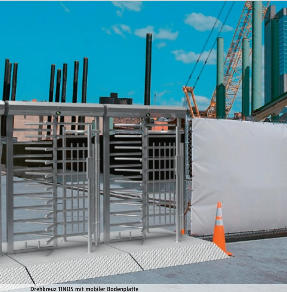
**Konstruktion:** Elektromechanisches Einzel- bzw. Doppel-Drehkreuz mit 3 Sektionen 120° und 10 Sperrarmebenen. Rahmen und Rotor aus Stahl bzw. Edelstahl. Beidseitige LED-Richtungs- und Statusanzeigen in der oberen Abdeckung (bidirektional nutzbar, individuelle Einstellung möglich). Bei Stromausfall dreht sich der Rotor frei. Schutzart IP 56, für den Außenbereich geeignet.
