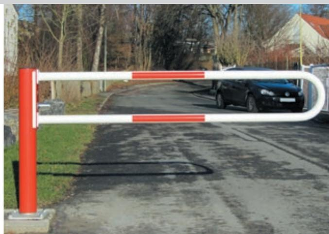
**Konstruktion:** Wegesperre in beide Richtungen öffnend, 360° drehend und alle 90° arretierbar. Bestehend aus Drehaufsatz aus Stahlrohr (Ø 121 mm), Hauptstütze aus Stahlrohr (Ø 102 mm) und einteiligem Stahlrohr-Sperrbügel (Ø 60 mm). Holmabstand mittig 300 mm.
