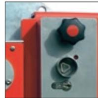
▲ Schlosskasten mit Feuerwehdreikant und Profilhalbzylinder für Hauptstütze
