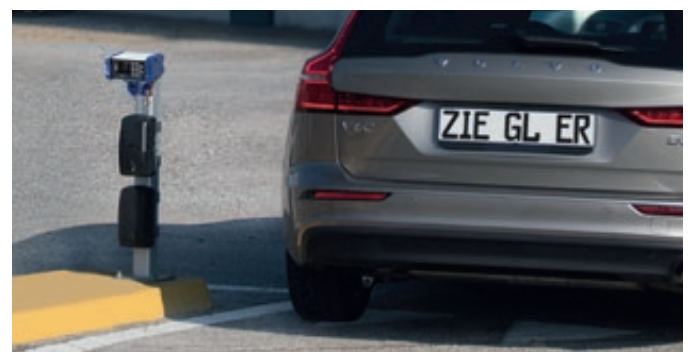
Kennzeichenerkennung ENNA mit integrierten Kameras kann als Standalone, mit lokalem Server oder über Cloudverwaltung eingesetzt werden.
