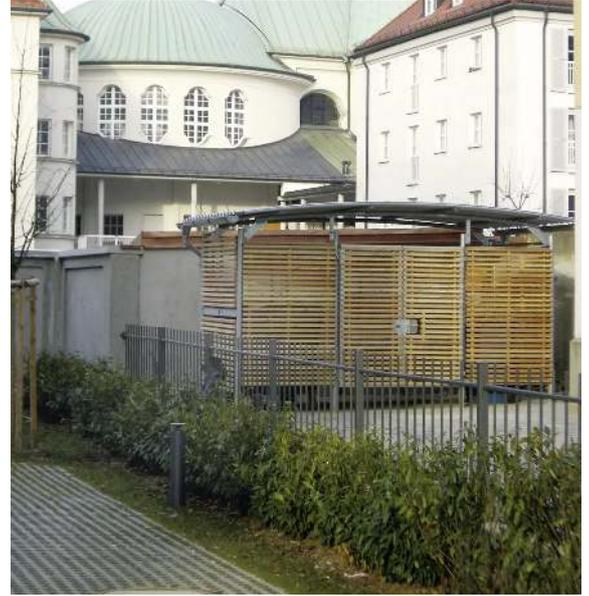
Wertstoffüberdachung BWA bausystem®, Dachbreite x Dachtiefe 4600 mm x 5600 mm, Stahlkonstruktion feuerverzinkt, Seitenwände und Doppelflügeltür aus Lärchenholz
