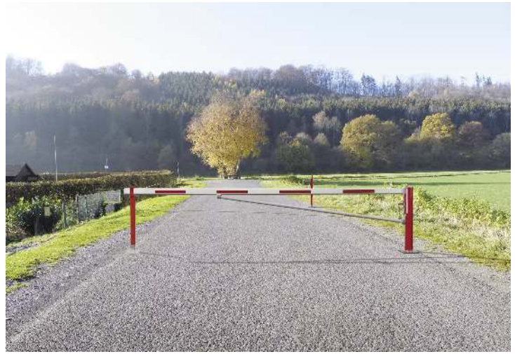
Wegesperre FLEN zum Aufdübeln, mit Diagonalstrebe und zwei höhenverstellbaren Auflagestützen, Sperrbreite 4,5 m
