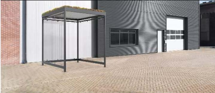
Raucherunterstand LEONIS GREEN mit auftragsbezogener Anpassung (zusätzliche Windschutzwand), Dachbreite x Dachtiefe 3180 mm x 2165 mm, Rückwand Trapezblech, Seiten- und Windschutzwände, ESG, Klarglas, Sitzbank, Stahlkonstruktion in RAL 7016 anthrazitgrau
