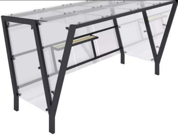
Raucherunterstand TAURI, Dachbreite x Dachtiefe 3940 mm x 2500 mm, einseitig, Dacheindeckung VSG, Rückwand ESG, Klarglas, Seitenwand ESG, Klarglas bzw. perforiertem Stahlblech, Stahlkonstruktion in RAL 7016 anthrazitgrau
