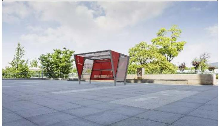
Raucherunterstand TAURI, Dachbreite x Dachtiefe 3940 mm x 2500 mm, einseitig, Dacheindeckung VSG, Rückwand perforiertes Stahlblech, Seitenwand ESG, Klarglas bzw. perforiertem Stahlblech, Stahlkonstruktion in RAL 9006 weißaluminium
