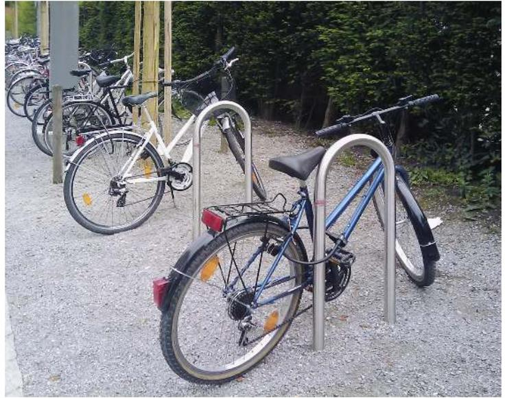
Anlehnbügel OKLAHOMA zum Einbetonieren, Edelstahl
