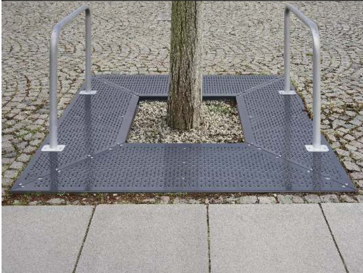
Baumschutzrost TABER, Breite x Tiefe 2000 x 2000 mm, mit Fahrradabwehrbügel aus verzinktem Stahl, Unterkonstruktion verzinkt, Blechprofil-Segmente mit Prägung City in RAL 7016 anthrazitgrau
