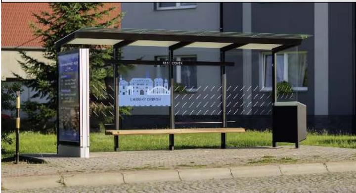
Wartehalle TRAXO, Dachbreite x Dachtiefe 5560 mm x 1740 mm, Rück- / Seitenwand ESG, Klarglas, mit Siebdruckdekor und bauseitiger Beklebung sowie Werbevitrine, Abfallsammler (auftragsbezogen), Sitzbank Thermoholz Esche, Stahlkonstruktion in RAL 9005 tiefschwarz
