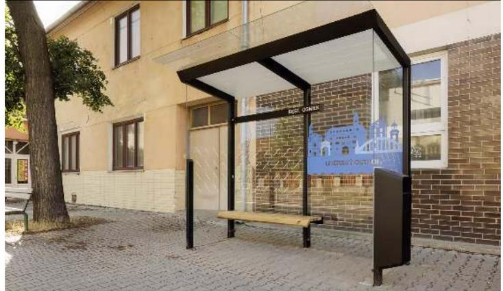
Wartehalle TRAXO, Dachbreite x Dachtiefe 5560 mm x 1740 mm, Rück- / Seitenwand ESG, Klarglas, mit Siebdruckdekor und bauseitiger Beklebung sowie Werbevitrine, Abfallsammler (auftragsbezogen), Sitzbank Thermoholz Esche, Stahlkonstruktion in RAL 9005 tiefschwarz
